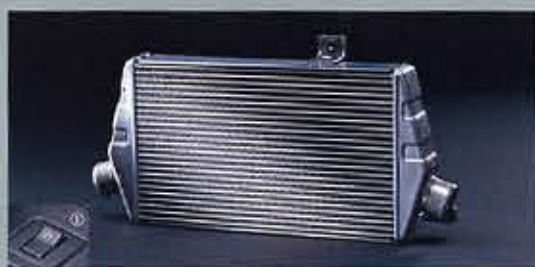
大容量インタークーラー 写真中①のスイッチは、センターコンソール部にあり、2つのスプレーによりインタークーラーとラジエーターに水を噴射し、冷却する。この冷却システムによって、低・中域のエンジン出力を向上させている。
