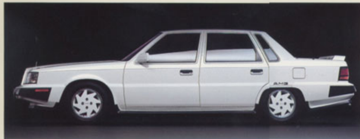
●AMGエアロパーツは、フロントバンパスポイラ、フロントグリル、サイドステップパネル、ドアプロテクションパネル、リアスポイラ、リアバンパスポイラ、リアエンドパネル、ホイールカットモールで構成されています。
