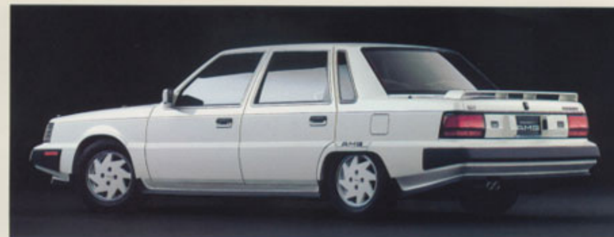
●AMGエアロパーツは、フロントバンパスポイラ、フロントグリル、サイドステップパネル、ドアプロテクションパネル、リアスポイラ、リアバンパスポイラ、リアエンドパネル、ホイールカットモールで構成されています。
